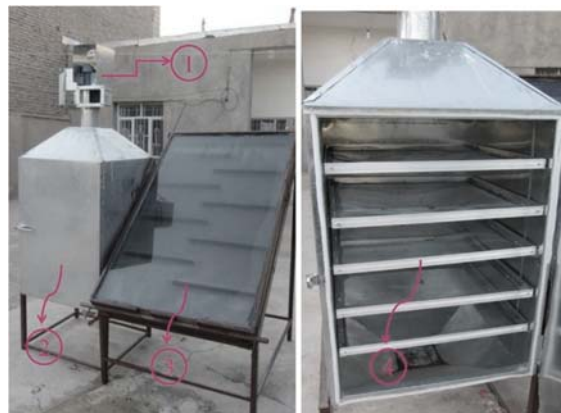
شکل شماره ۱- ساختار کلی سامانه خشک‌کن طراحی شده در این مطالعه به همراه اجزاء: (۱) فن سانتریفوژ، (۲) محفظه خشک‌کن، (۳) جمع‌کننده خورشیدی، (۴) سینی‌های خشک‌کن.
